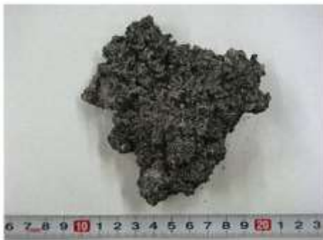
写真3 水砕槽底部残留メタル
